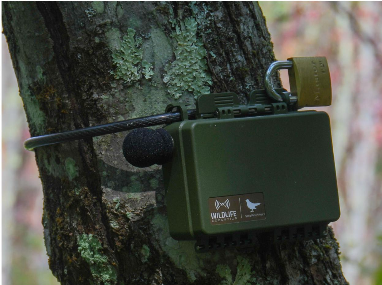
Las esquinas superior izquierda y superior derecha de la carcasa del Song Meter Mini 2 incorporan unas anillas por las que se puede pasar un cable de seguridad para fijar el grabador a un árbol o estructura. El diámetro del cable debe ser inferior a 10,67 mm (0,420 in.) para pasar por estas anillas.
