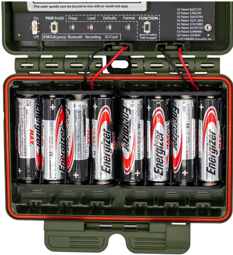
El compartimento de pilas AA contiene dos bandejas de plástico para pilas. Cada bandeja tiene capacidad para cuatro pilas AA y puede alimentar la grabadora con cuatro u ocho pilas AA en total.
