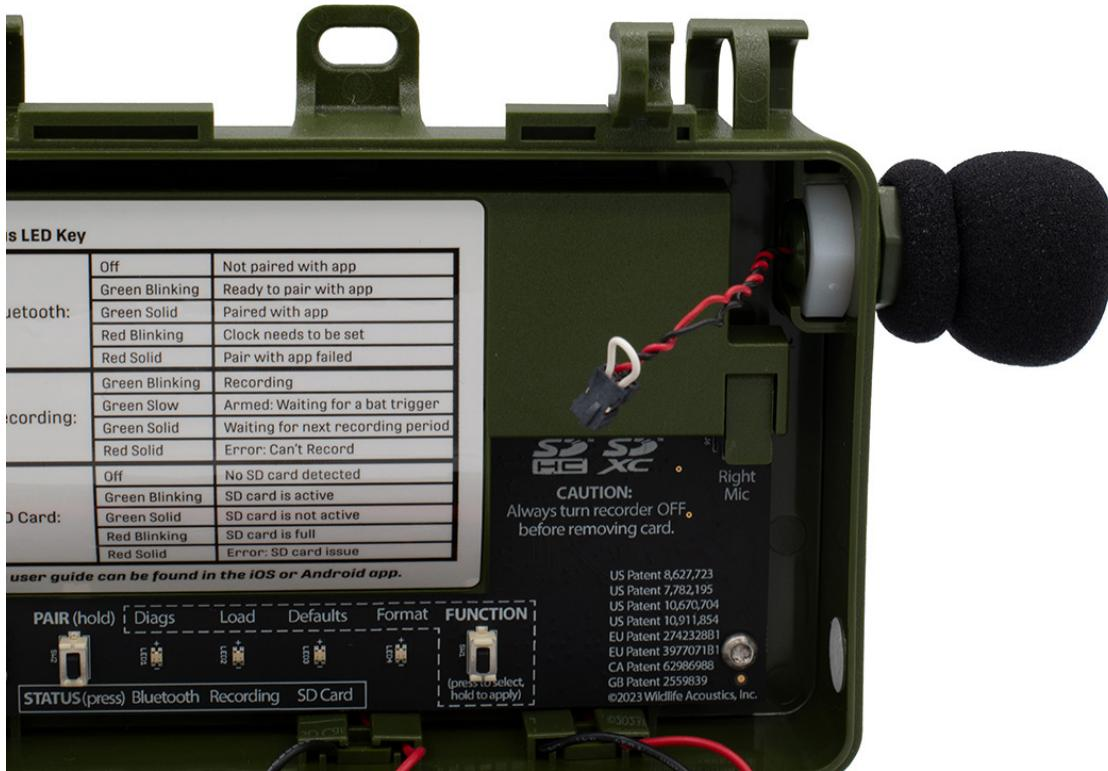
4. Gire con la mano el micrófono en el sentido de las agujas del reloj para enroscarlo en la tuerca interna. Asegúrese de que los cables del micrófono no queden atrapados mientras gira el micrófono. Asegúrese de que la rosca del micrófono esté alineada con la rosca de la tuerca hexagonal.
