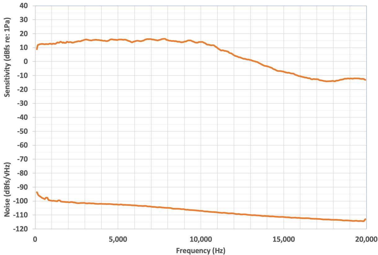
**Figura 10. Sensibilidad y umbral mínimo de ruido, escala de frecuencia logarítmica**
