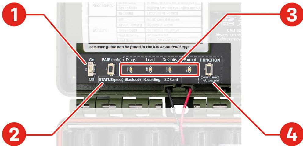
1. El interruptor **ON/OFF** (encendido/apagado) enciende el grabador o lo pone en un estado inactivo de bajo consumo. Consulte [Interruptor ON/OFF \(Encendido/Apagado\) \(en la página 29\)](#).
