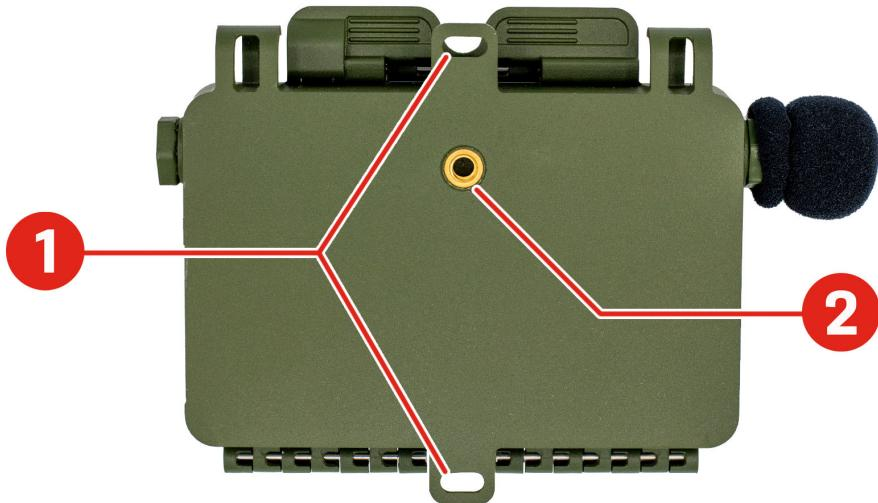
1. Las **pestañas de montaje** superior e inferior pueden alojar pernos o tornillos con un diámetro de rosca máximo de 4,6 mm (3/16 in.). También pueden servir como puntos de fijación para elásticos o bridás.
