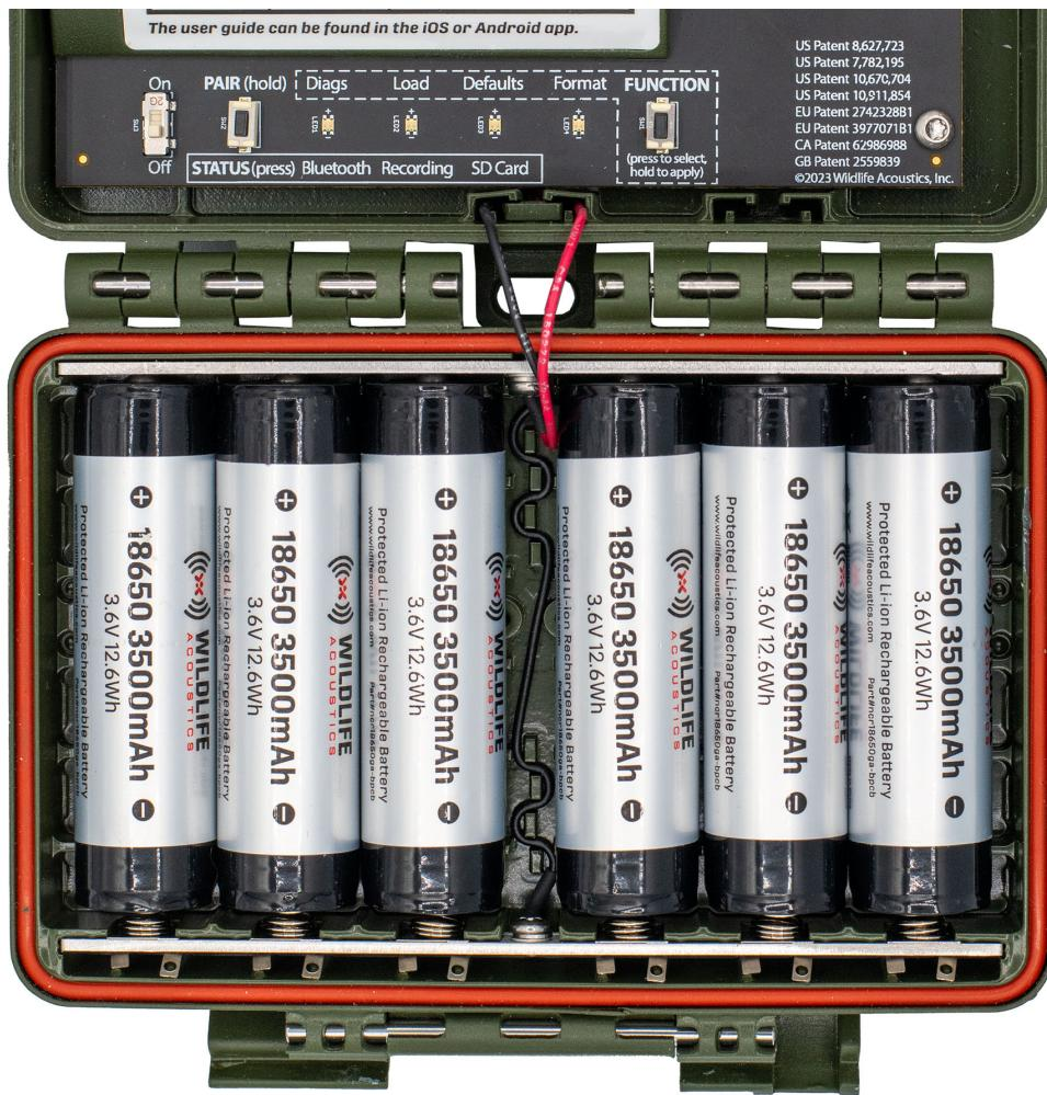
La tapa de la versión de iones de litio del Song Meter Mini 2 tiene capacidad para entre una y seis baterías de iones de litio 18650. Aunque puede instalar cualquier número de baterías 18650 en cualquiera de las ranuras y el grabador funcionará según lo previsto, cuantas más baterías use, más tiempo funcionará. Consulte [Requisitos de las baterías de iones de litio \(en la página 137\)](#) para obtener más información sobre cómo elegir las baterías adecuadas.
